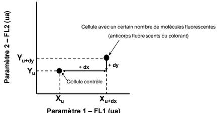
Exemple d'une cellule marquée par un colorant fluorescent qui émet principalement dans le Paramètre 1 (fluorescence verte) mais aussi dans le Paramètre 2 (fluorescence orange)
