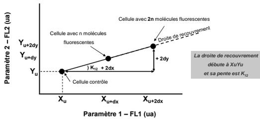
Exemple de cellules marquées par différentes quantités d'une molécule fluorescente qui émet principalement dans le vert (paramètre 1)
